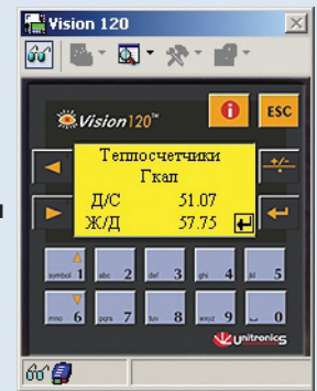
Табл. 1, рис. 8. Реальный доступ к контроллеру V120-22-R1 котельной «БМ» «Горловкатеплосеть» 06.04.2007 г., 14 час 08 мин («Д/С» – детский садик, «Ж/Д» – жилой дом)
