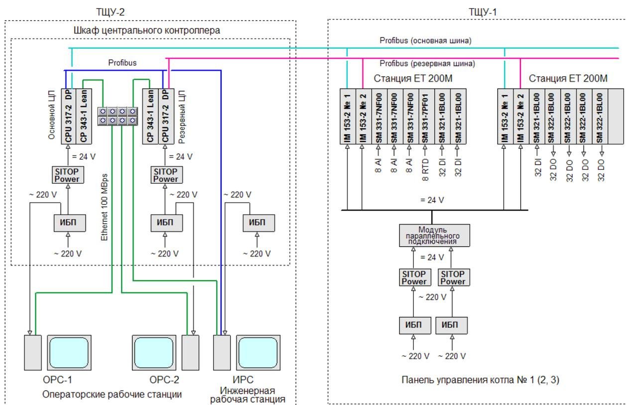
Операторские рабочие станции помимо, выполнения основной функции – обеспечение интерфейса «оператор – система», осуществляют архивирование технологической информации, т. е. играют роль локальных архивных станций.
